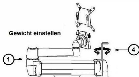
Den Arm parallel zur Tischplatte halten und mit der Justierschraube das Gewicht des Monitors einstellen.
